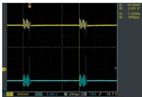
Die Störungen auf dem Ausgang des Abstandssensors (gelb) stammen von der Versorgungsspannung (blau).
