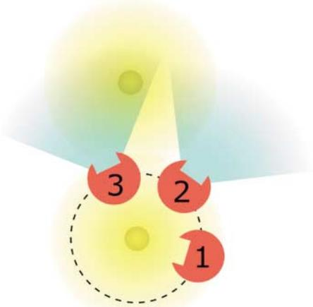
Die beleuchtete Säule nimmt der Bot fest ins Visier (1). Nach Drehung und Bogenfahrt von 20 Zentimetern prüft er, ob sich im grünen Sektor eine weitere Slalomstange befindet (2) – falls nicht, setzt er die Fahrt fort und prüft anschließend erneut (3).
