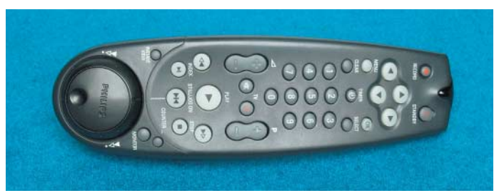
Eine handelsübliche RC5-Infrarotfernbedienung steuert den c't-Bot und übermittelt ihm die Wünsche seines Besitzers.
