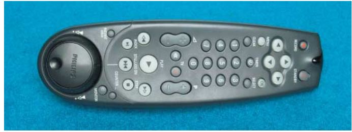
Eine handelsübliche RC5-Infrarotfernbedienung steuert den c't-Bot und übermittelt ihm die Wünsche seines Besitzers.
