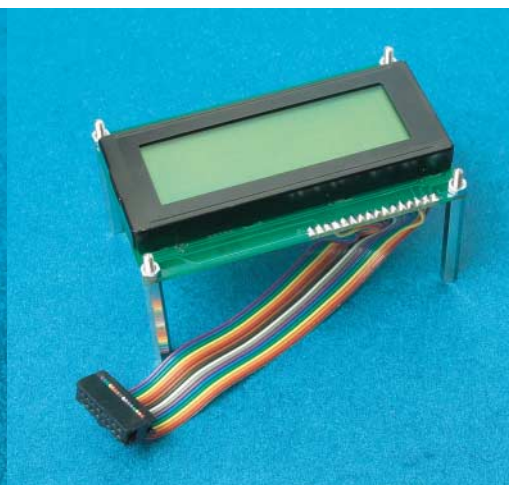
Auf einem Display für 4 × 20 Zeichen zeigen die Testprogramme Statusinformationen über den c't-Bot an. Das erleichtert die Fehlersuche allgemein.
